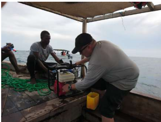
Fig. 35 Motobomba ao serviço da sugadora.
