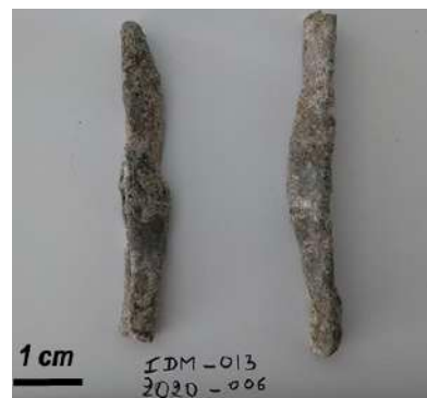
Fig. 87 Fragmentos de chumbo da calafetagem (© Collin).
