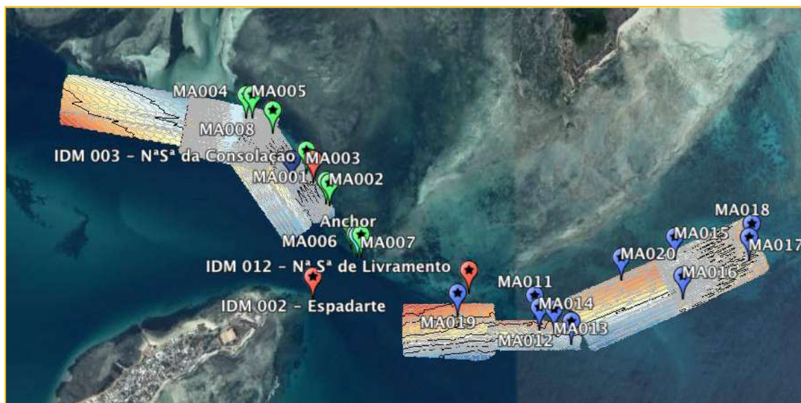
Fig. 22 Visão dos blocos de levantamento por magnetômetro e anomalias identificadas junto ao recife da Cabaceira Pequena e ponta norte da Ilha de Moçambique (© Sharfman 2016/2017).
